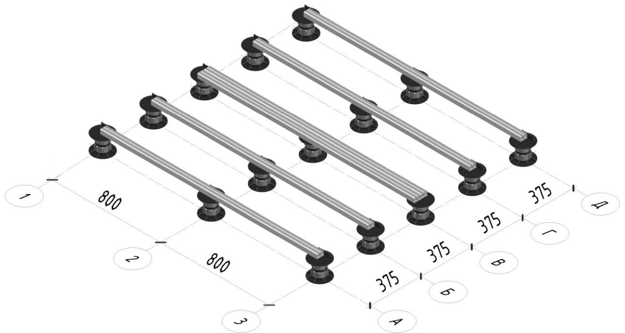
Рис. 4.2. Схема расположения регулируемых опор при использовании алюминиевой лаги 75
